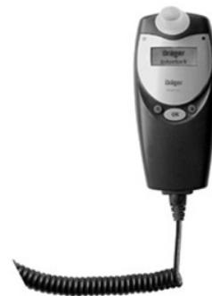
Het alcoholslot bevat een soort brandstofcel. Als de uitgeademde lucht alcohol bevat, reageert de alcohol als reductor aan de ‘actieve’ elektrode van de cel. De vergelijking van deze halfreactie is:
